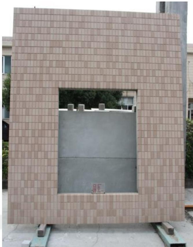
预制混凝土马赛克外墙板
